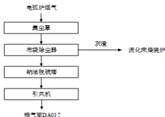
图 7.1-6 电弧炉烟气净化流程图
