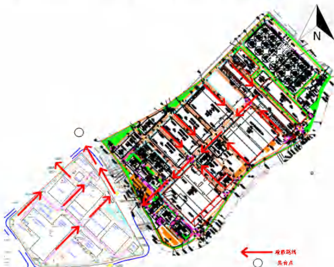
图 6.2.7-6 事故情形下疏散路线图
