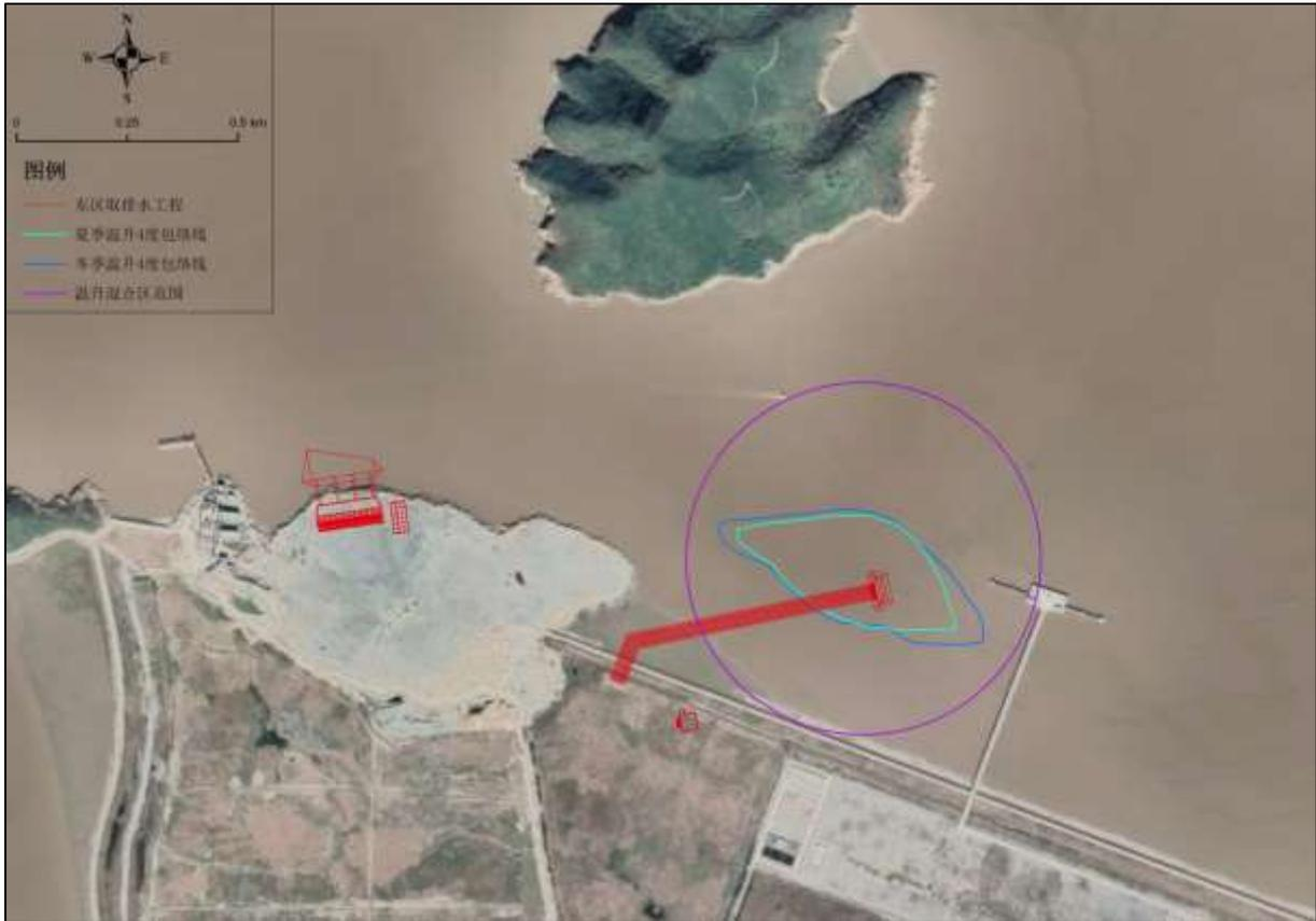
图 6.2-17 东区温排水口温升混合区范围图
