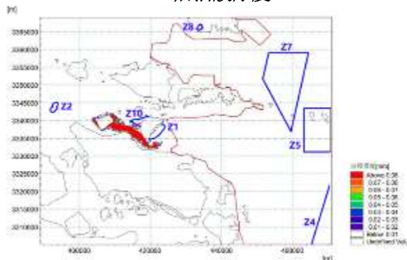
夏季 SSE, 5.6m/s 条件涨潮时刻溢油发生 12h 后油膜厚度
