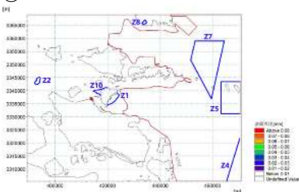
静风条件落潮时刻溢油发生 1h 后油膜厚度
