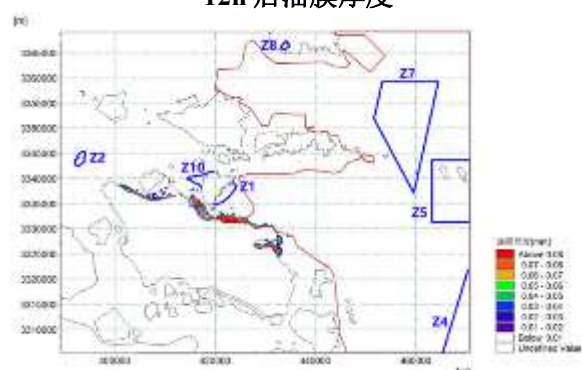
冬季 NW, 5.4m/s 条件落潮时刻溢油发生 24h 后油膜厚度
