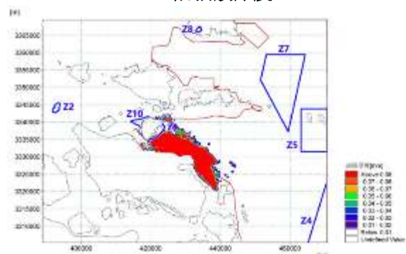
不利 W, 13.8m/s 条件涨潮时刻溢油发生 24h 后油膜厚度
