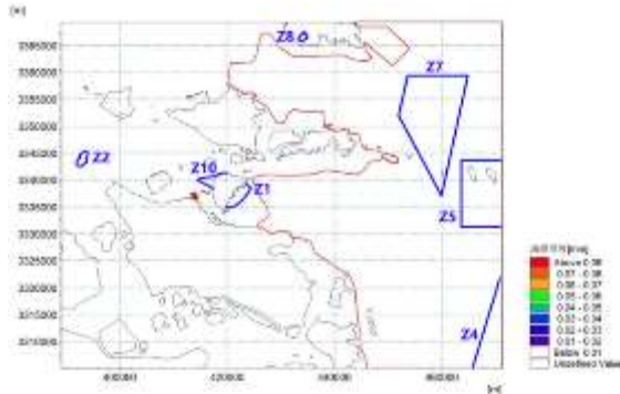
夏季 SSE, 5.6m/s 条件落潮时刻溢油发生 1h 后油膜厚度
