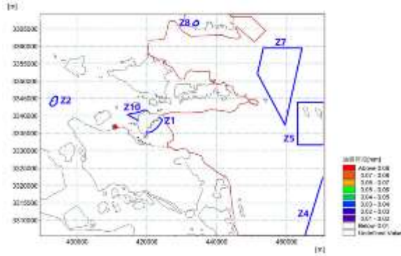
静风条件涨潮时刻溢油发生 1h 后油膜厚度
