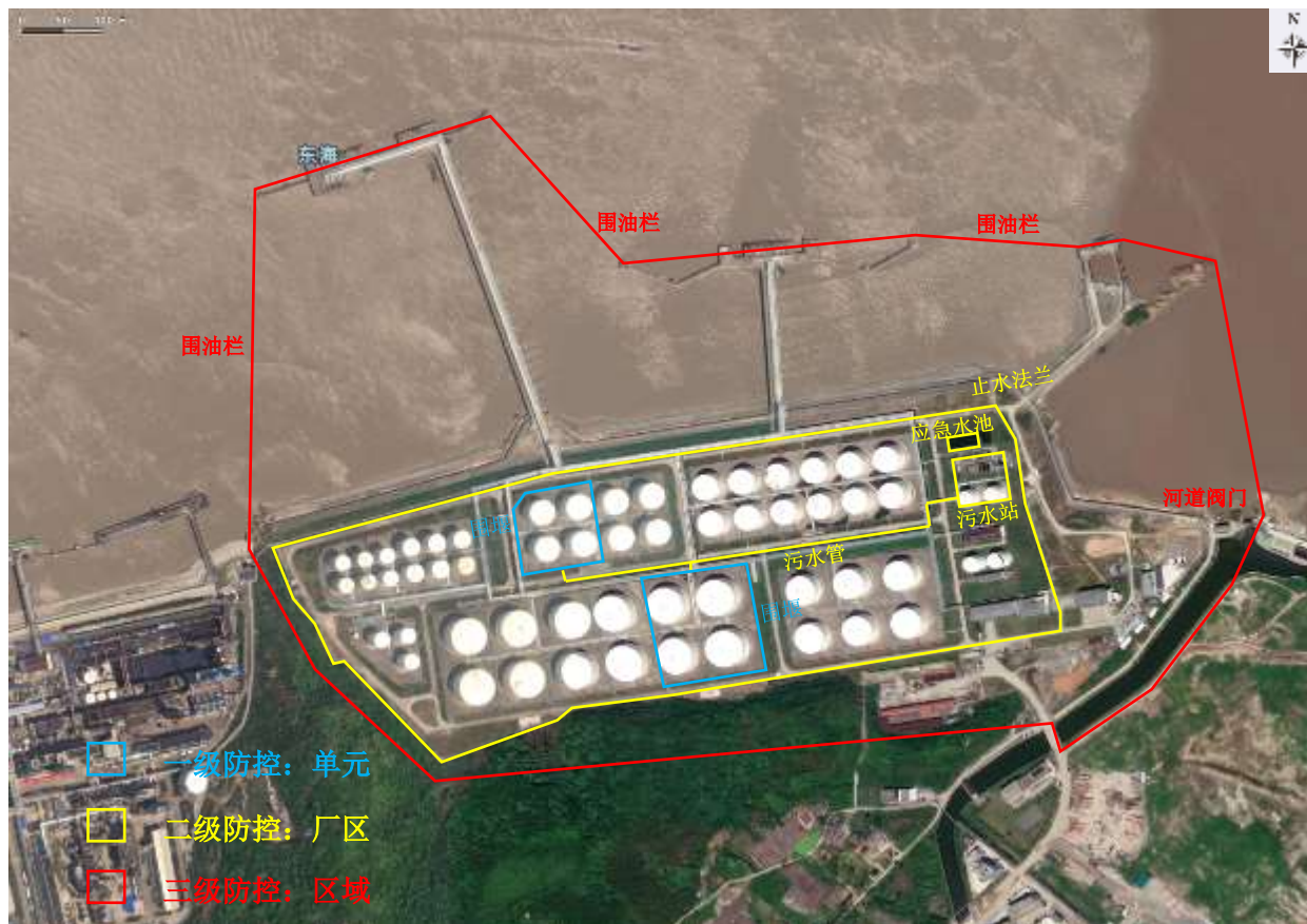
图 7.7-9 技改项目事故污水三级防护体系图
