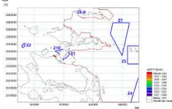
冬季 NW, 5.4m/s 条件落潮时刻溢油发生 1h 后油膜厚度
