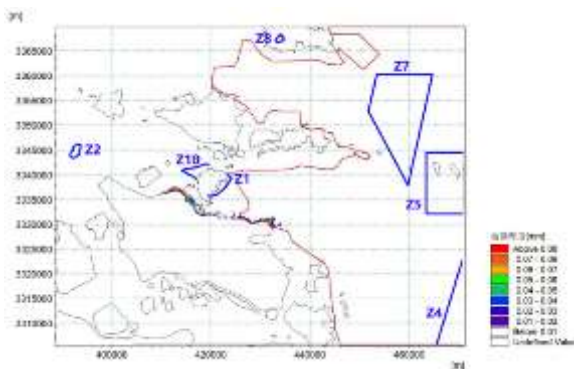
冬季 NW, 5.4m/s 条件涨潮时刻溢油发生 24h 后油膜厚度
