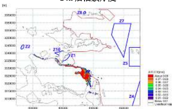
冬季 NW, 5.4m/s 条件落潮时刻溢油发生 48h 后油膜厚度
