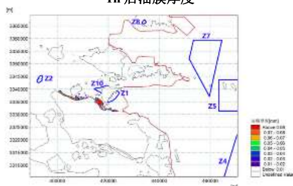
冬季 NW, 5.4m/s 条件落潮时刻溢油发生 12h 后油膜厚度
