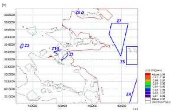
不利 W, 13.8m/s 条件涨潮时刻溢油发生 1h 后油膜厚度
