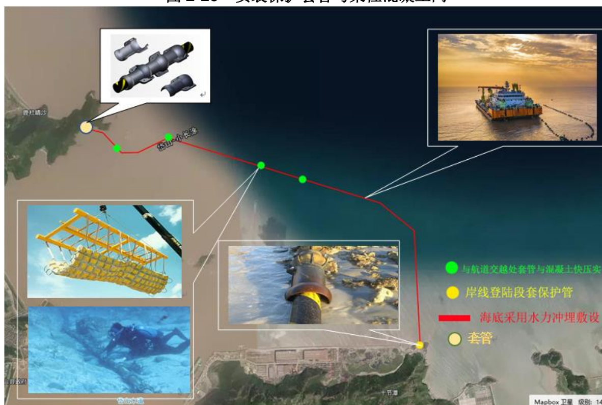
图 2-16 本项目路由施工工艺段分布图
