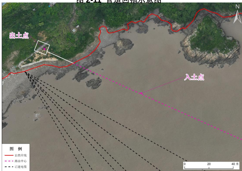
图 2-12 岱山登陆点定向钻出入土位置示意图
